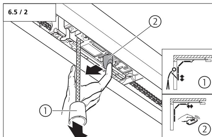
1. Tor und Motor-Aggregat trennen.
