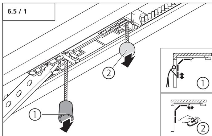
1. Tor und Motor-Aggregat trennen.
