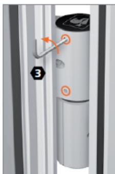
Gewindestifte mit einer  $\frac{1}{2}$ -Umdrehung lösen.
