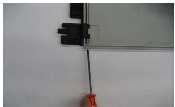
4. Metallachse aus Scharnierbohrung stossen
