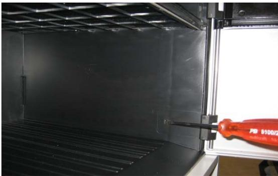
1. Mit Schraubenzieher in untere Öffnung drücken, Scharnier lösen
