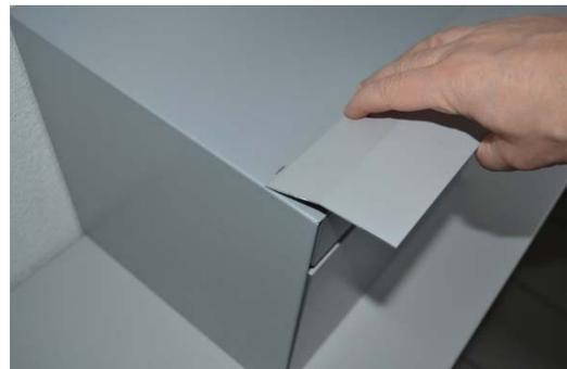
4. Regenleiste an Positionsmarken ausrichten, links/rechts zentrieren
